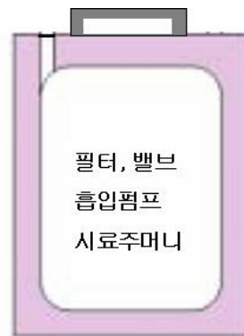
(b) 휴대용 폐시료채취기를 이용한 시료채취장치
