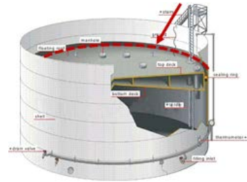
< 그림 4-209 > 외부부상지붕형 저장시설 저장탱크 내벽과 부유지붕 상단 가장자리
