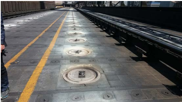
< 그림 4-159 > 코크스로 코크스 장입구 밀봉 예시
