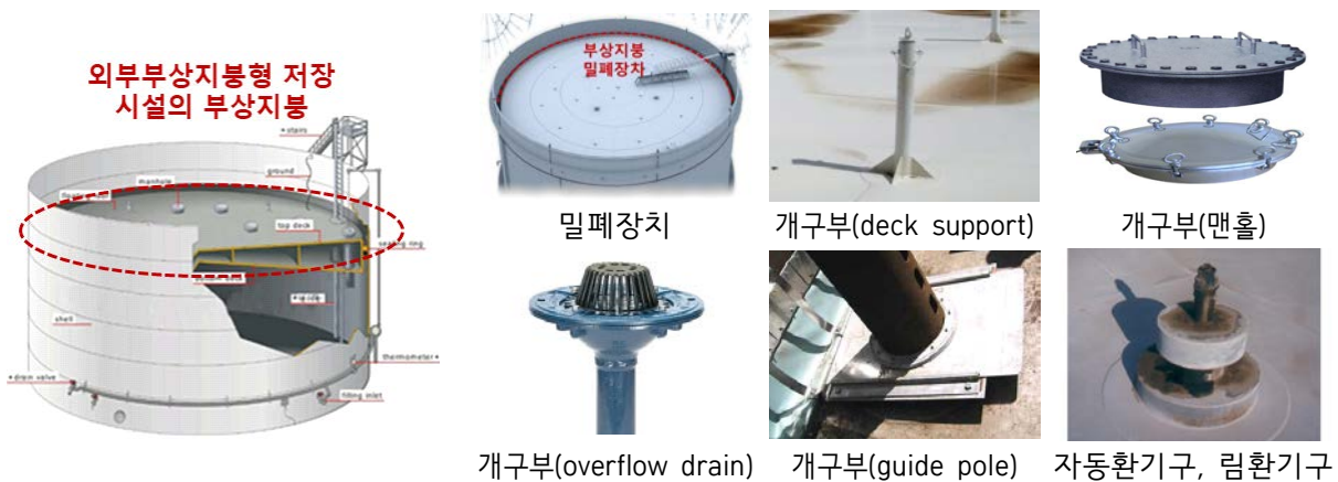
[ 외부부상지붕형 저장시설의 부상지붕 ]
