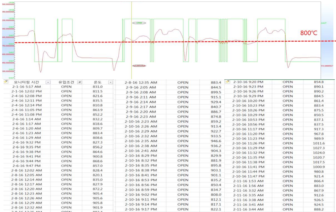
< 그림 4-180 > 보일러, 가열기, 소각시설 운영기록부 증빙자료(연소실 온도 모니터링 자료) 예시
