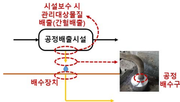
< 그림 1-20 > 공정배수구 및 배수장치 구조
