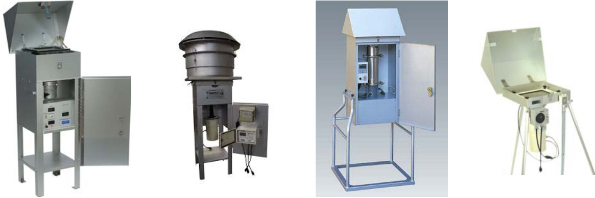
< 그림 4-122 > 비산먼지 고용량/저용량 시료채취장치 예시
