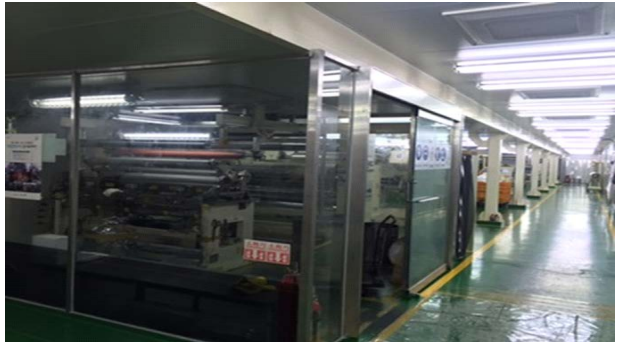
[ 고정식 벽체(유리)로 설치된 작업공간 ]
