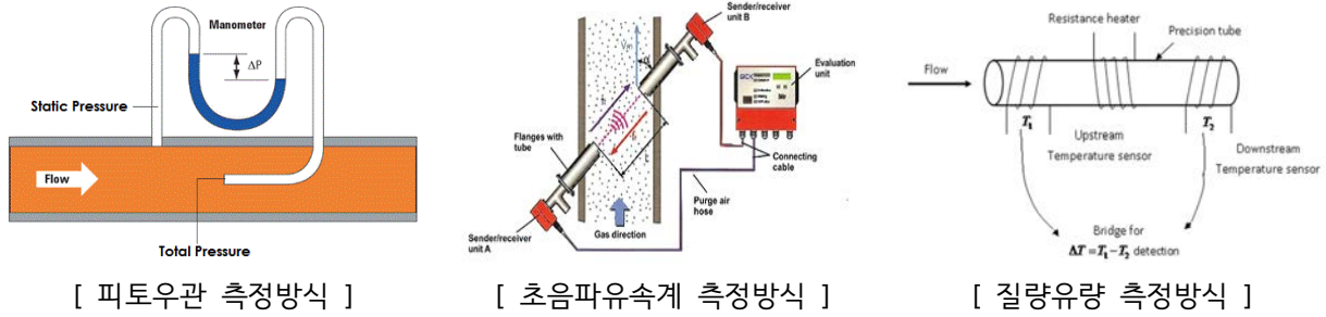
< 그림 4-34 > 플레어스택 유량 측정방식 예시
