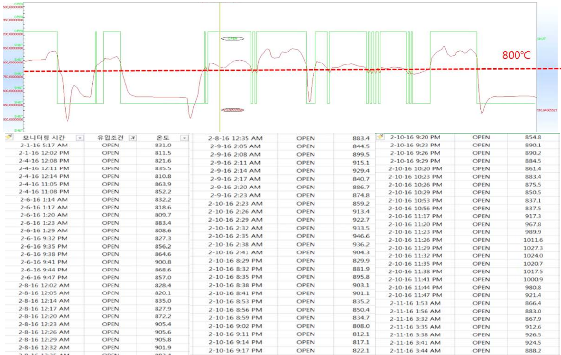
< 그림 4-8 > 보일러, 가열기, 소각시설 운영기록부 증빙자료(연소실 온도 모니터링 자료) 예시
