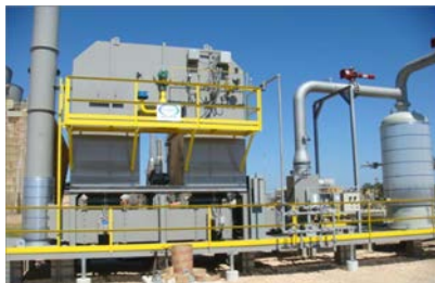
[ 축열식 연소산화시설 예시 ]
