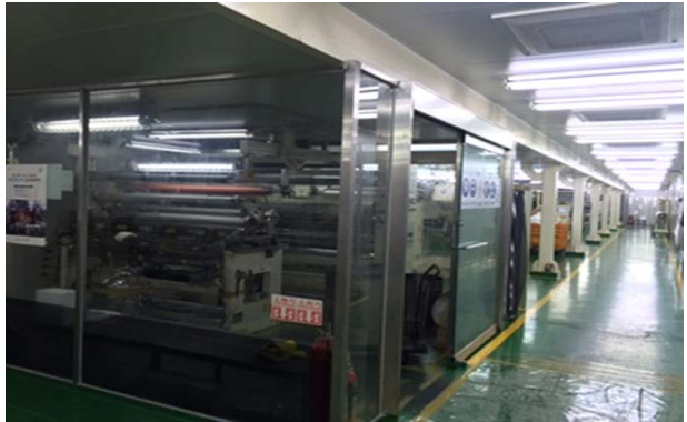
[ 고정식 벽체(유리)로 설치된 작업공간 ]
