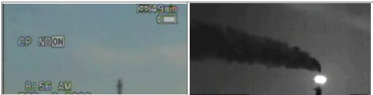
< 그림 4-41 > 플레어스택 광학가스탐지카메라 모니터링 예시
