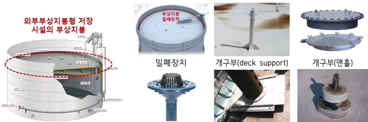
[ 외부부상지붕형 저장시설의 부상지붕 ] 개구부(overflow drain) 개구부(guide pole) 자동환기구, 림환기구 [ 외부부상지붕형 저장시설 부상지붕 누출원 ]
