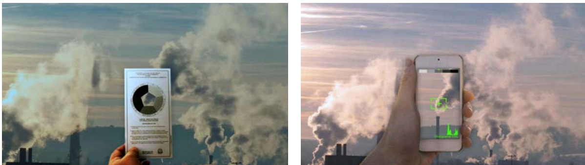
[ 매연 측정방법(링겔만 매연 농도표) ] [ 매연 측정방법(광학적 불투명도) ]
