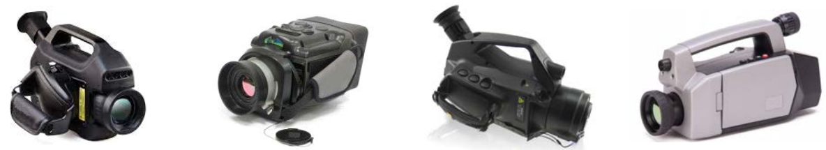
< 그림 4-38 > 광학가스탐지카메라(휴대용) 예시
